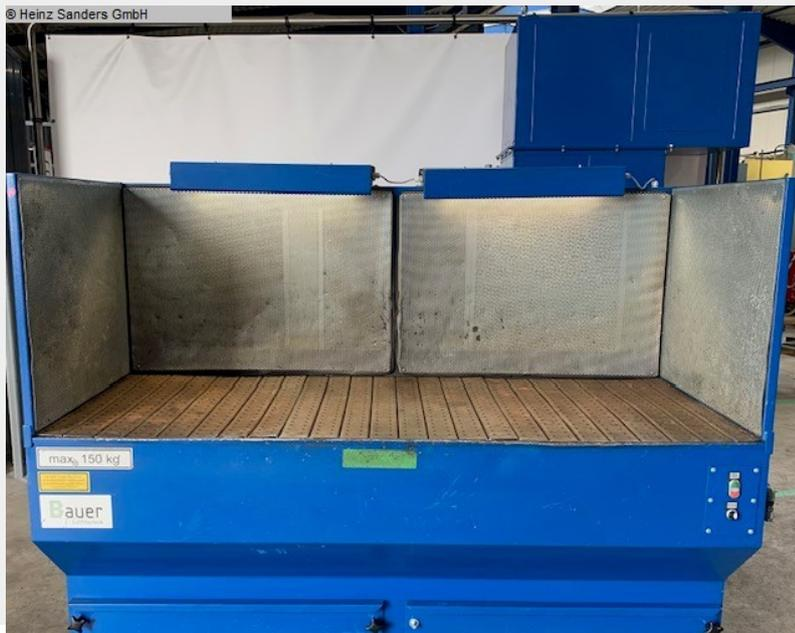
Das Filtergerät wird zum Absaugen und Filtern von Rauchen oder Stäuben eingesetzt.
